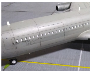
Particolare del portello di carico, delle antenne a lama e dei finestrini resi ciechi
