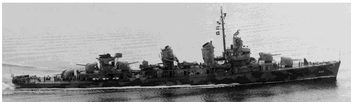
Profilo del cacciatorpediniere in cui sono esposti tutti gli armamenti in dotazione tra i quali le cinque torrette a cannone singolo e le due postazioni di lanciasiluri brandeggiabili
