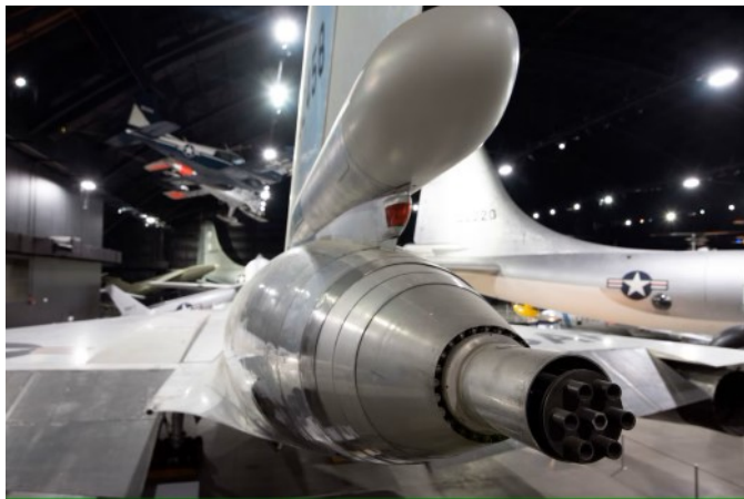
Particolare della coda in cui è posizionato il cannoncino a canne rotanti per la difesa
